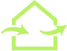
Besonders wirksam ist die **kurze Querlüftung** (Durchzug). Mit diesen Massnahmen wird in kurzer Zeit viel Feuchtigkeit abgeführt. So wird das Auskühlen der Wand- und Deckenoberflächen verhindert. Dazu wird auch eine Menge Heizenergie gespart. Sowohl bei Regen als auch bei Nebel sind die Lüftungsmassnahmen durchzuführen.
